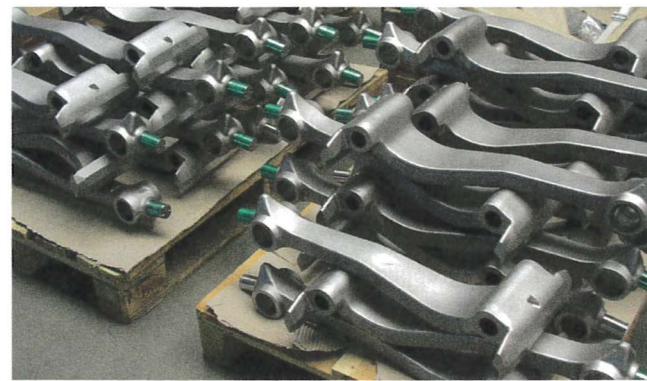
Die Spezialteile der Seilbahnsysteme werden mit einem zweischichtigen Zinklamellensystem beschichtet. Dies bietet einen hohen Korrosionsschutz bei einer maximalen Schichtdicke von 50 µm.
