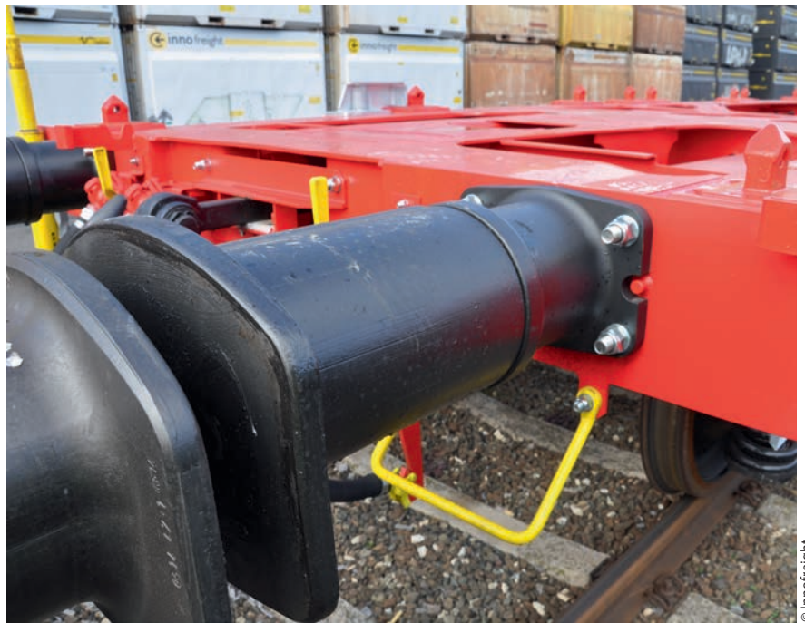
Die Zug-/Stoßeinrichtung und der Kopf der Waggon-Einheit. Die Eigenschaften des Lacksystems sind exakt auf die Bedürfnisse des Güterwagenverkehrs zugeschnitten.
